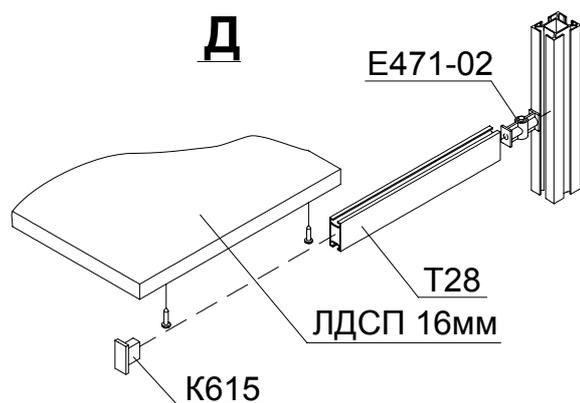
1. К стойкам с помощью замков E471-02 закрепить отрезки профиля T28.
